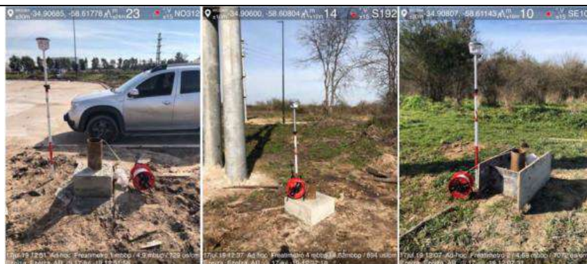
Figura 4. Registro de niveles estáticos (Acuífero freático), conductividades y vinculación altimétrica con GPS diferencial.
